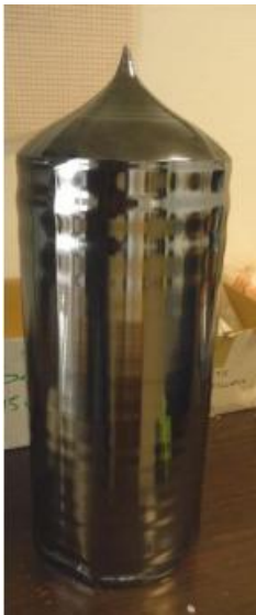
Şekil 4.5. Czochralski yöntemi ile oluşturulmuş bir silikon kütük (PHOTOSIL Consortium, 2011)
