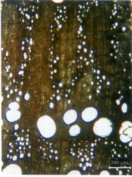
Şekil 98. Kay-Akmeşe Grubu Örneği Odunun Enine Kesiti (Örnek no: YK 12 döşek 89E-23) (Kocabaş, 2008, s. 207 ).
