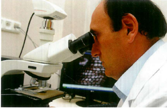
Şekil 116. Mikroskopta Örnek Teihisi Ekranda Odunun Enine Kesiti Görülmekte, Sağ Tarafda Ekranda Odunun Mikroskop Görüntüsü Görünmekte (Akkemik, 2015, s. 17).
