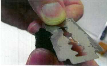
Şekil 115. Örneklerin Jiletle İnce Kesit Alınması (Akkemik, 2015, s. 16).
