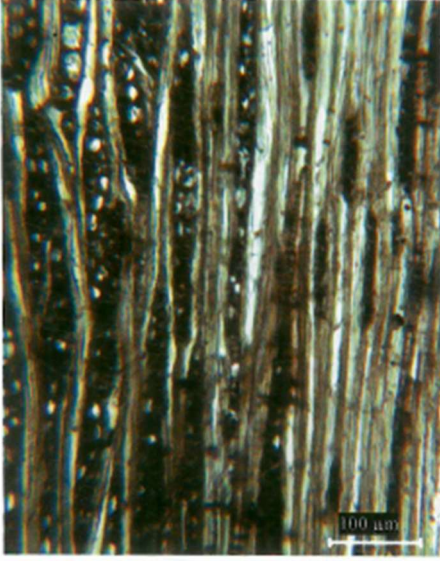
Şekil 106. Gürgen Odunu Enine Kesiti (Örnek no: YK 12 Döşek E-16), (Kocabaş, 2008, s. 209).
