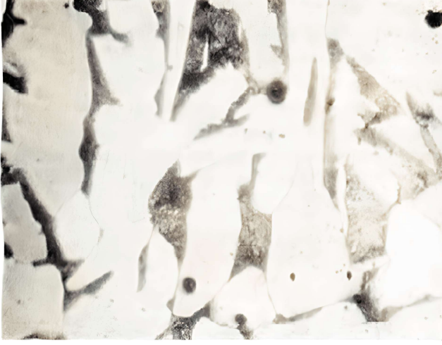
Şekil 39. Demirin Tipik Mikro Yapısı. Açık Alanlar Ferrit Koyu Bölgeler ise Perlittir. Yapı, Elle Su Birikintisi Yapılmış Bir Ferforjeden Yapılmış Olup, Cüruf Kalıntılarından Oldukça Arınmıştır (Bass, ve Doorninck, 1982, s. 322).
