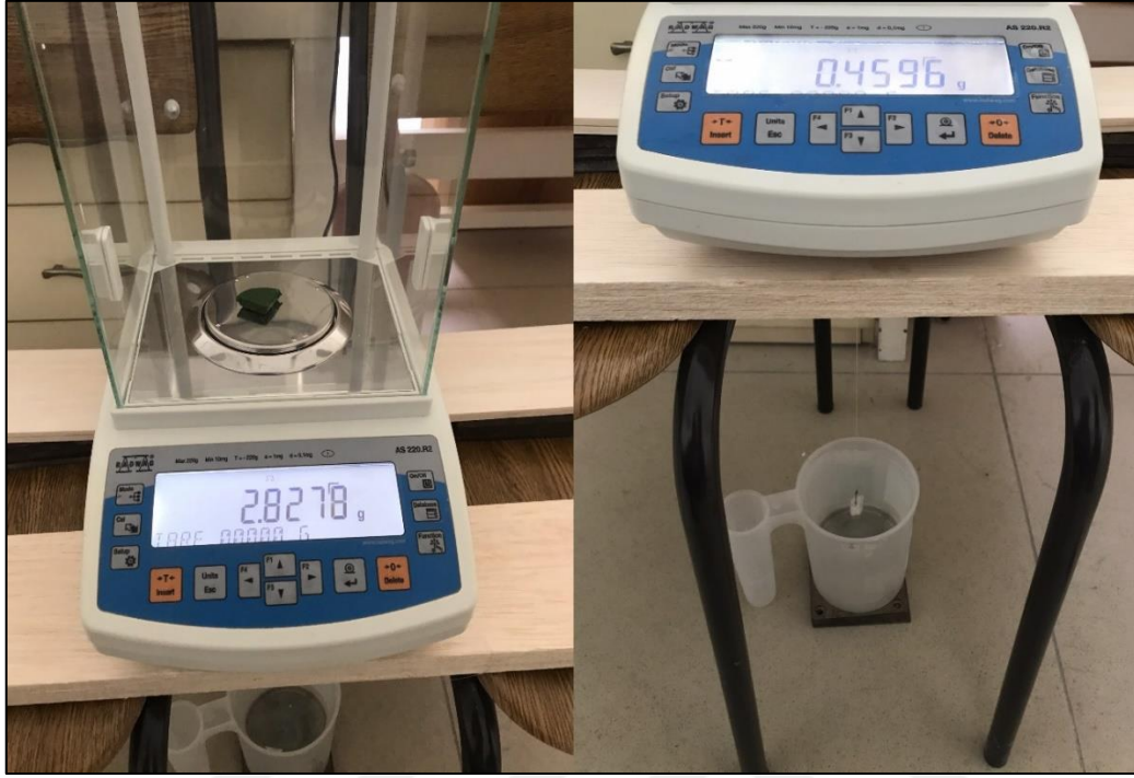
Şekil 3.5 Antimon ve krom numunelerinin Arşimet hesapları
