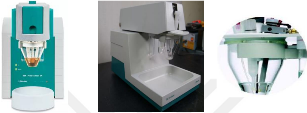
Şekil 4.2 Metrohm marka 757 VA Computrace model voltametrik analiz cihazı ve voltametrik hücre
